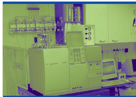
*Analizador elemental para la determinación de nitrógeno total*
