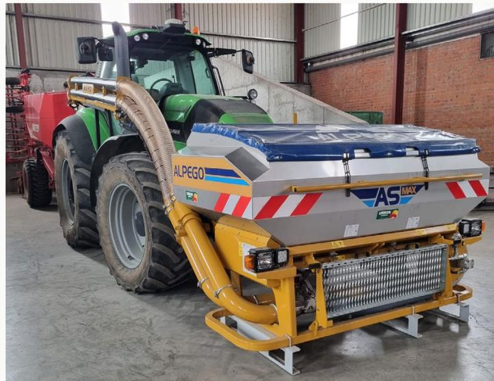
**FIGURA 3.** Tolva delantera para abonado en línea de siembra.
